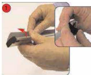
Ouvrir le rail clippant supérieur et faire pivoter l'embout pour ouvrir le rail
