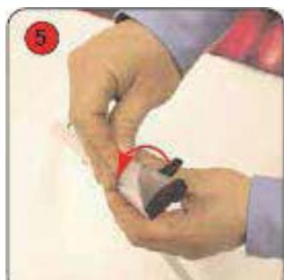
Ouvrir le rail clippant inférieur et faire pivoter l'embout pour ouvrir le rail
