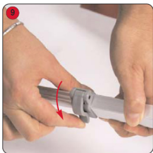
9 Refermer le clip afin de bloquer la position
